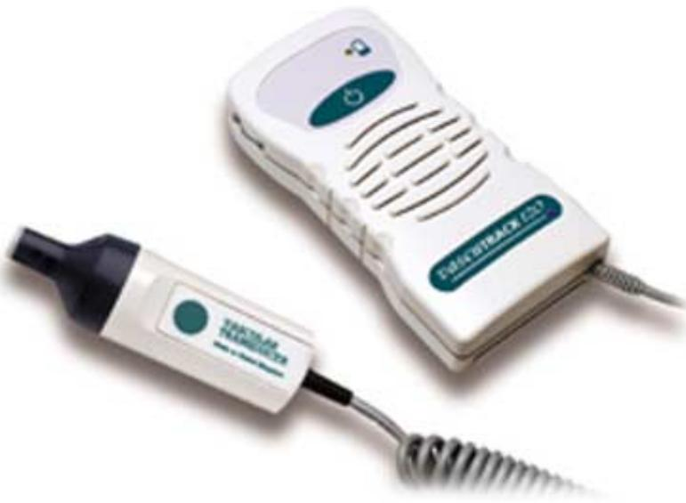
Vascutrack 120 es un instrumento básico para la detección del flujo vascular, es pequeño, ligero y contiene una sonda de alta sensibilidad Doppler de 5,4 MHz. Transductor de fácil limpieza incluido. Alta calidad de sonido.
