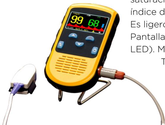
Este Pulsioxímetro es capaz de monitorizar la saturación de Oxígeno (SpO<sub>2</sub>), el ritmo del pulso y el índice de perfusión a través del dedo del paciente. Es ligero, de tamaño reducido y fácil de transportar. Pantalla de alta resolución de LCD (retro- iluminada por LED). Memoria de hasta 72 horas de datos.
